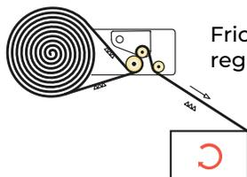
Fricción mecánica regulable manualmente.
