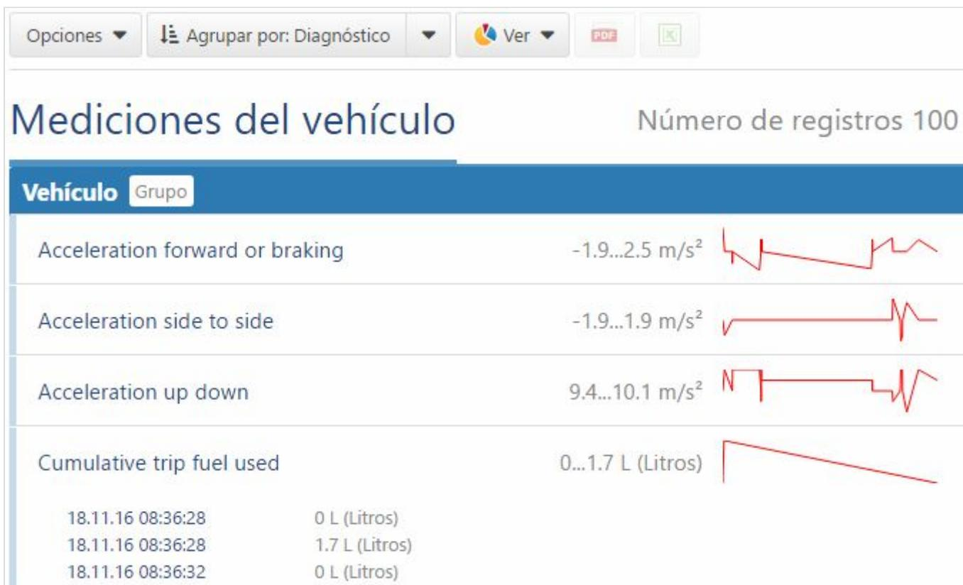
Al seleccionar una fila de la lista se mostrarán mediciones específicas y la fecha y hora de cuándo se registraron. Al hacer clic en el minigráfico de líneas rojas verá el gráfico del perfil de datos del motor para las mediciones seleccionadas.
