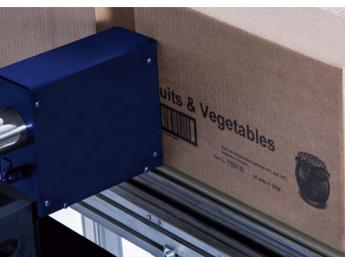
Diseñadas y fabricadas para imprimir textos, imágenes, logos, símbolos y todo tipo de códigos de barras, 100% legibles y compatibles con los estándares de GS1 (GTIN13, GTIN14, GS1-128, GS1 Datamatrix...) para embalajes secundarios de superficie porosa; tales como cajas y bandejas de cartón corrugado, sacos de papel, etc.
