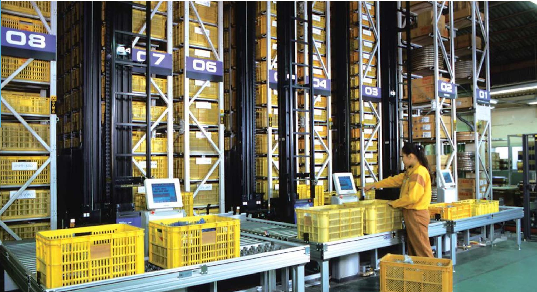
Dentro de la gama de productos para un almacenamiento automático se encuentra una **herramienta altamente productiva: el Miniload**. Esta solución se puede diseñar a la medida de cada cliente, lo que **permite almacenar totes y cajas uniformes**.
