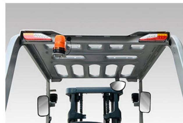
Espejo retrovisor frontal y laterales, faros delanteros, luces traseras de led y luz estroboscópica.
