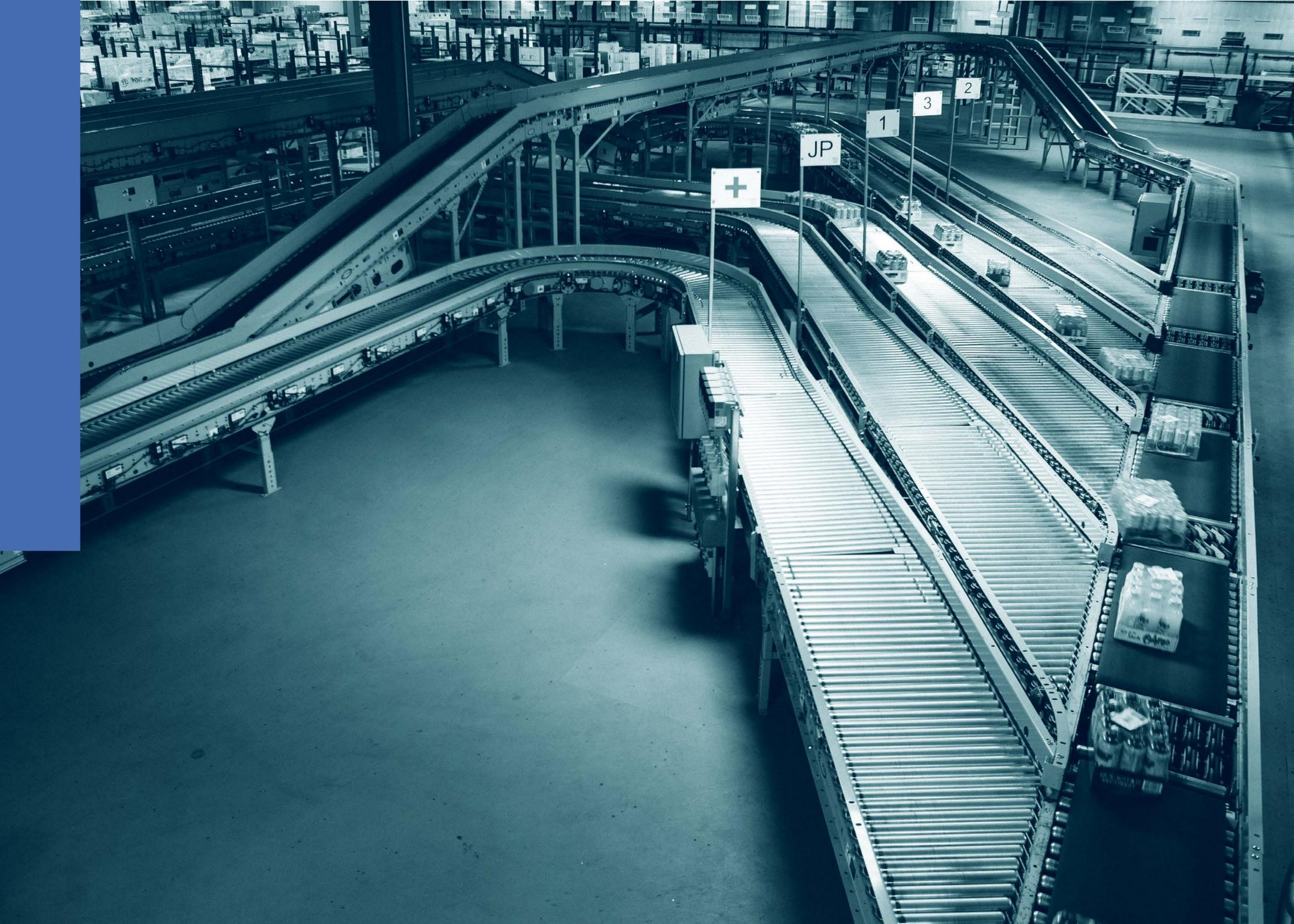
Cada driver está compuesto por dos o tres hiladas de ruedas traccionadas por bandas, posterior al inducir el equipo en una salida. Es de suma importancia que la salida "Take Away", sea motorizada para que el producto salga correctamente.
