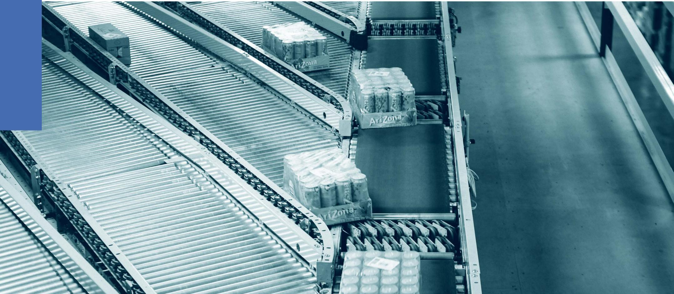
Este sorter está constituido por una sola banda a lo largo de toda su longitud. Gracias a su diseño, se pueden intercalar diferentes desviaciones "drivers", las cuales desvían el producto mediante un accionamiento simultáneo que levanta y rota el sentido de las cajas y permite sacar el producto.
